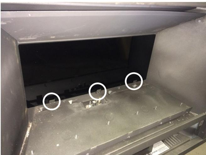
**Étape 02 :** Placez le panneau latéral gauche dans la chambre de combustion le long du côté du plateau du brûleur et fixez-le avec une attache. (livré en kit)
